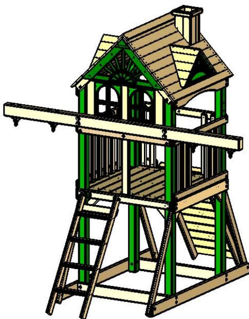
5" INSIDE OF CORNER POST TO SIDE OF WINDOW. ADJUST AS REQUIRED.
