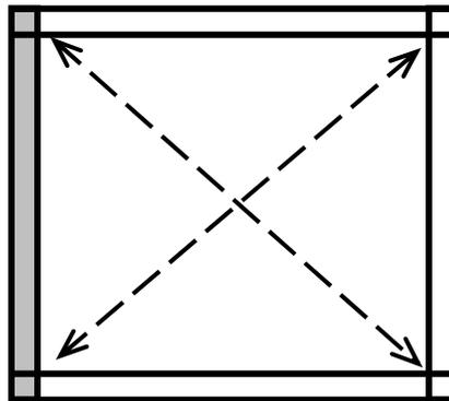
THE DIAGONAL MEASUREMENTS SHOULD BE THE SAME FROM CORNER POST TO CORNER POST. IF NOT, ADJUST FORT SO THAT THE DISTANCE IS EQUAL.
