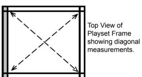
SHOULD BE THE SAME FROM CORNER POST TO CORNER POST. IF NOT, ADJUST FORT SO THAT THE DISTANCE IS EQUAL.
